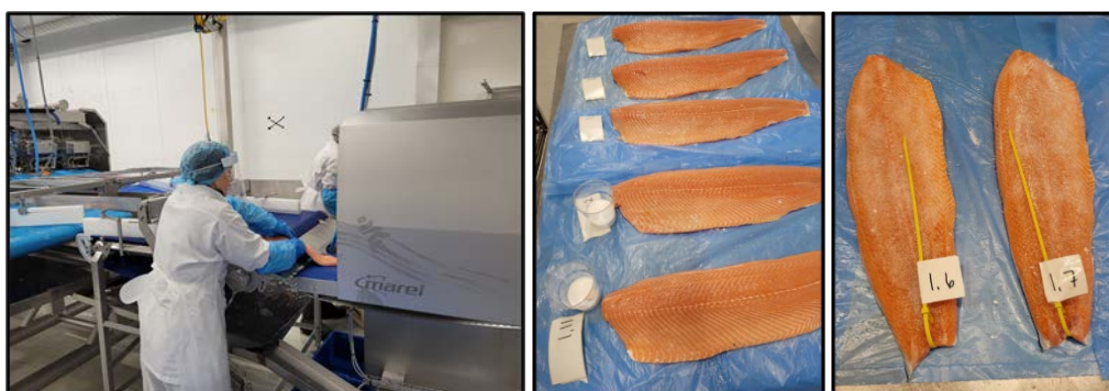
Bilde fra Pilotproduksjonen av røkt laks med salterstattere. Plukking av fileter, salting og merking (Foto: Kristian Rolland).
